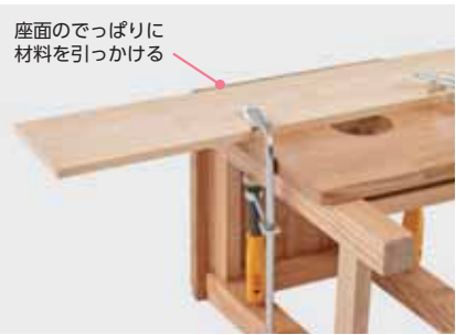
図1 クランプを用いた材料の固定方法（左：工作台、右：いす）
