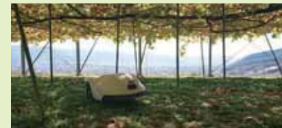
自動走行型ロボットによる草刈りのようす（岩手県花巻市）
